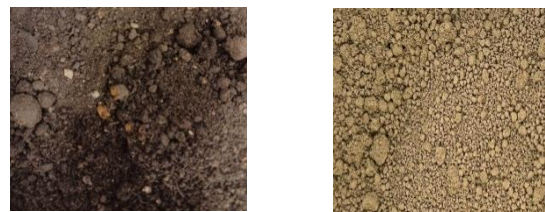
Fig.1. Sols pollués à l'antimoine (gauche) et au molybdène (droite) retenus pour la thèse.
