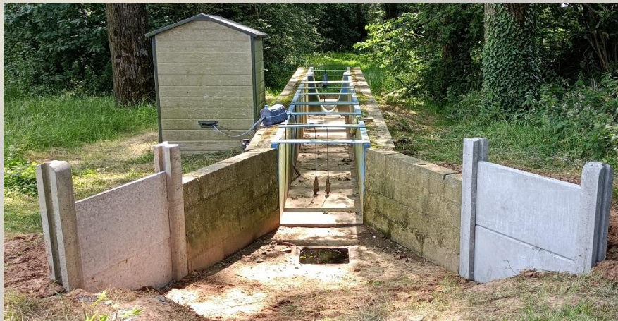
Figure 2 : station de mesure haute fréquence (mesure du débit, de la turbidité et prélèvement d'échantillons)
