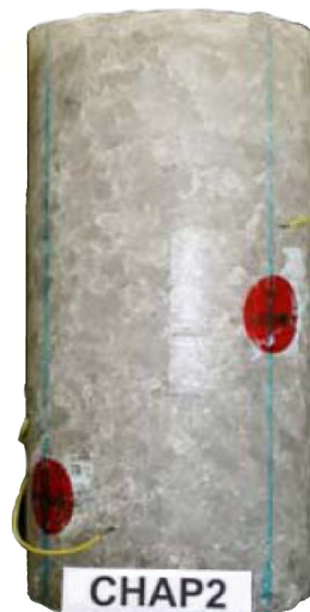
Jauges collées sur une éprouvette de sel avant essai Gauges glued on a salt sample before test
